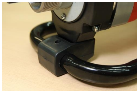
Виброизоляция рамы, резиновые амортизаторы.
