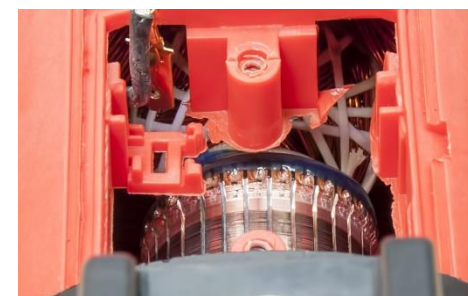
Защита ротора от частиц пыли (дополнительный бандаж).
