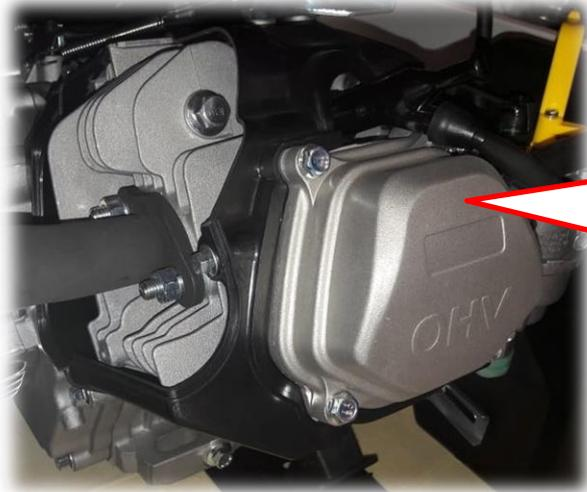
Добавлен металлический дефлектор и увеличены ребра головки цилиндра, что позволило эффективно снизить рабочую температуру головки цилиндра до 225°C (GX200: 230°C, Остальные  $\geq 250^\circ\text{C}$ ).
