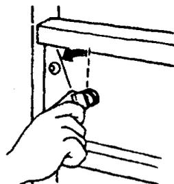
– После того, как электростанция остановится, закройте топливный кран - положение “OFF”.
